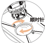
A.清洁干净后,再装回机器内,提杯需要顺时针旋转,当提杯小三角形与不锈钢过滤器的小三角正对时,表示提杯已旋紧。
