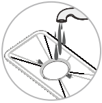
A.用流动水冲洗不锈钢过滤器,也可以用软毛刷清洗,但不可用铁刷或不锈钢丝球刷,这样会让不锈钢过滤器生锈。
