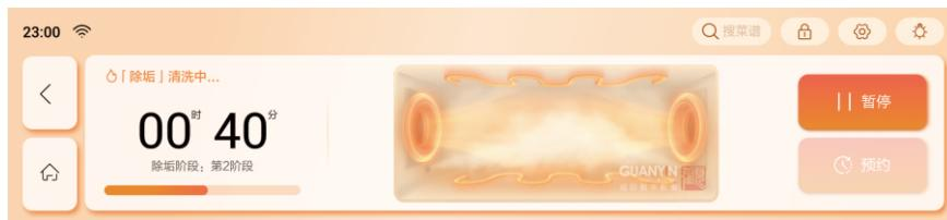
第三步：第一阶段完成后，请根据机器弹窗提示加水并开始第二阶段除垢。
