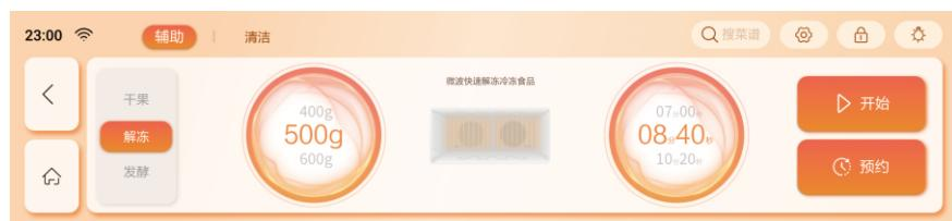
第二步：在上方菜单栏点按选择需要的主功能，在左侧选择主功能对应的模式，在模式页面滑动调整时间和温度。
