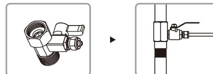
3. 按图示连接好机器及管路，为更换滤芯或检查机器并便于机器正常抽拉，电源线、进水管和浓水管必须预留 $\geq 400\text{mm}$ 的伸缩活动长度，并用卡扣限位固定。
