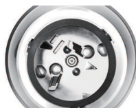
4. 用较长较硬的棍子(如螺丝刀等)触及研磨盘将其来回转动
