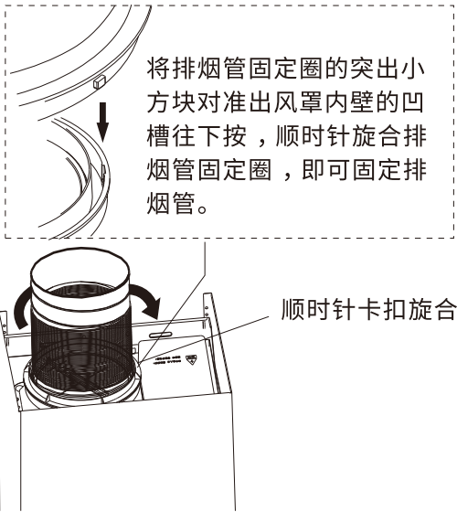
机头安装示意图(图片仅供参考)
